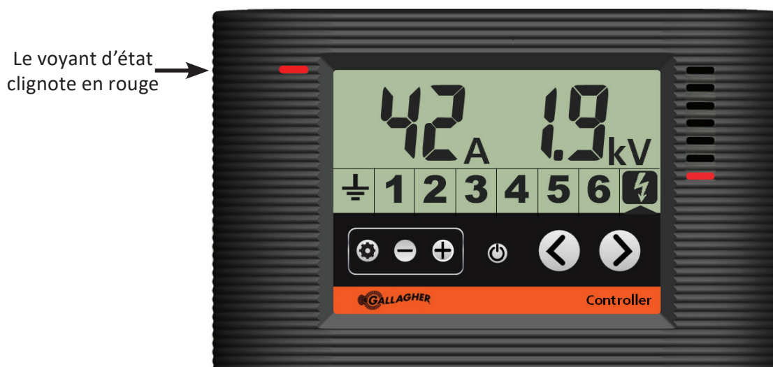
Contrôleur montrant l'électrificateur en état d'alarme
