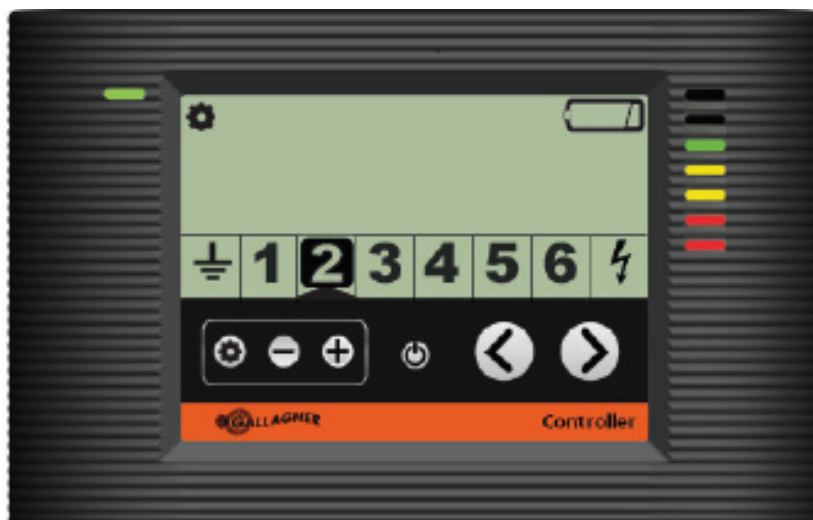
Styreenheden viser zone 2 med et lavt batteri
