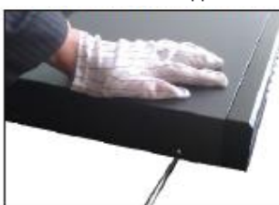
6. Bevestig de bovenste afdekking met de bijbehorende schroeven.
