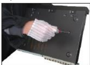
5. Bevestig de harde schijf met de bijbehorende schroeven.
