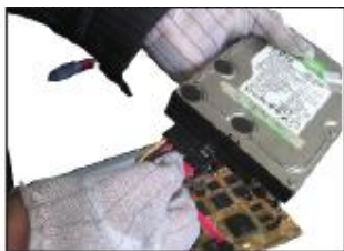
3. Conecte la línea de alimentación del disco duro.
