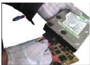
3. Brancher le câble d'alimentation du disque dur.
