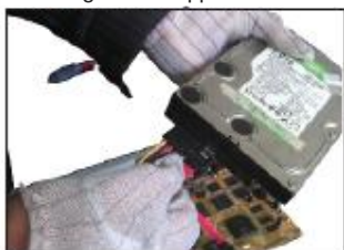
3. Sluit de voedingskabel van de harde schijf aan.
