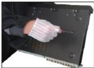
5. Fissare le viti del disco rigido.
