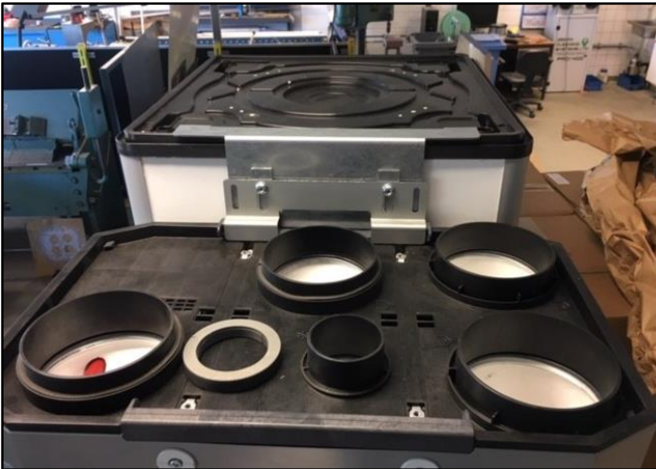
Figuur 1: HRU ECO 300 gemonteerd aan WPV
