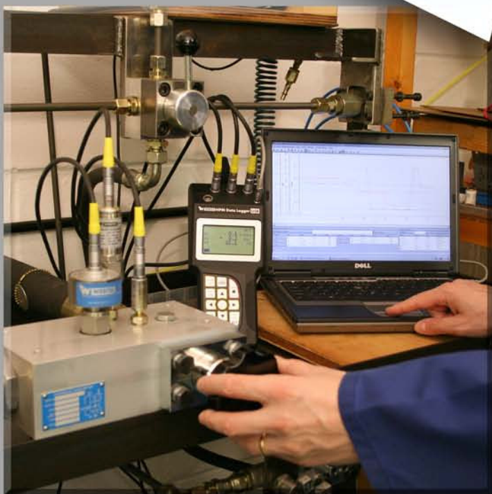
Fehlerfindung an einem Prüfstand, der HPM540 ist via USB mit einem PC verbunden
